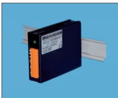
Zasilacz serii SPS-25 MD o mocy 25W (maks. 35W), z trzyletnią gwarancją. Zasilanie: 90-260VAC lub 110-390VDC, bardzo wąska obudowa (27,5mm), temperatura pracy od -40 do 70°C (pełne obciążenie)
